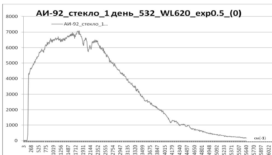
Рис. 9. Бензин АИ-92 спустя 1 день на стекле
